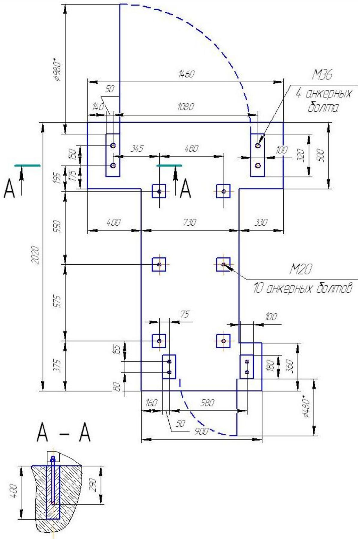
Рекомендуется станок устанавливать в отдельном помещении на фундаменте. Глубина заложения фундамента выбирается в зависимости от характеристик грунта, но должна быть не менее 600 мм. Выверка станка на фундаменте производится с помощью клиньев и уровня. Точность установки – 0,1 мм на 1000 мм. Окончательно выверенный станок подливается бетоном, а после затвердевания последнего крепится фундаментными болтами.
