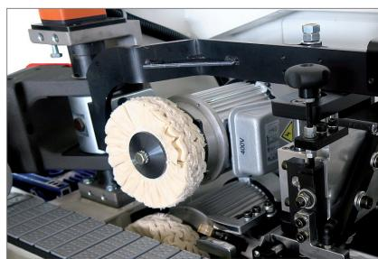
**Узлы полирования кромки**
